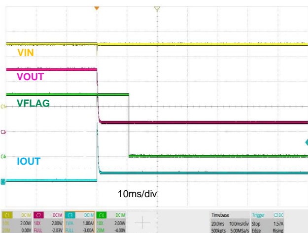
OCP Response( R_{SET}=20k\Omega , R_L=60\Omega to 2\Omega )
