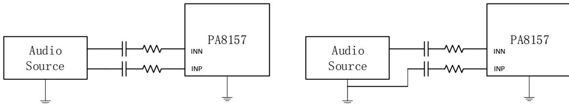
图 14. 典型差分/单端输入连接图
